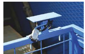
Кронштейн индикатора на ограждении
