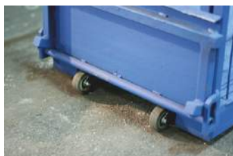
Встроенные колеса для перемещения весов.
