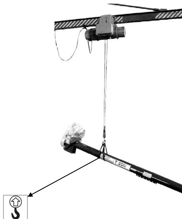
Naklejka informacyjna – punkt zaczepienia do podnoszenia
